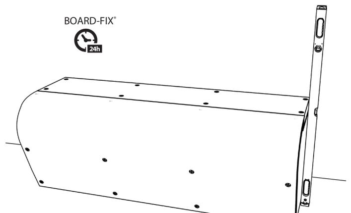
**12)** Le banc est collé contre le mur et au sol en vérifiant son positionnement à l'aide d'un niveau.
