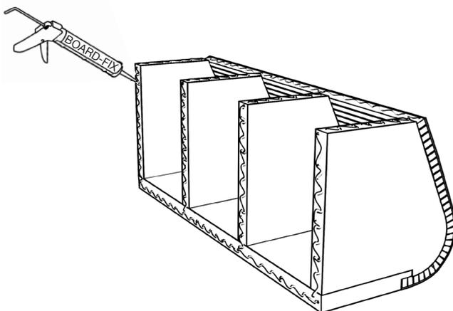
**11)** Le banc doit être collé contre le mur et au sol. À cet effet, la colle BOARD-FIX® est appliquée sur les faces chants au dos et du dessous.
