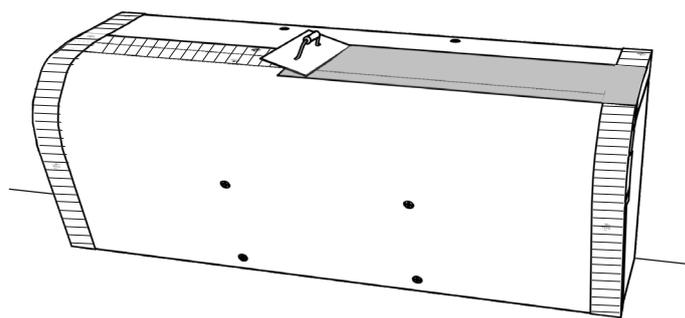
**14)** La bande d'armature est talochée à la colle à carrelages.
