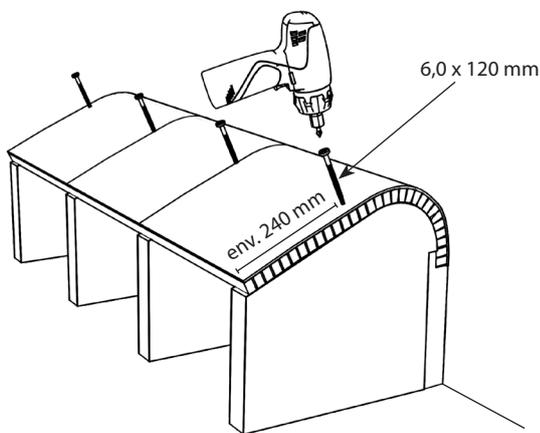
**9)** Le banc est posé sur le dos. Le panneau de recouvrement B2 est appliqué contre l'arrondi, plaqué et vissé.
