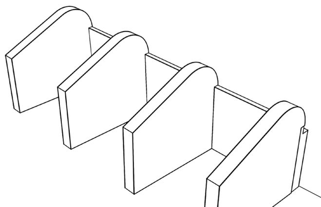
4) Le panneau de recouvrement B1 est redressé. Les panneaux supports A sont collés.
