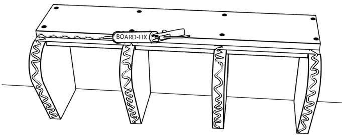
**7)** La colle BOARD-FIX® est appliquée sur les panneaux supports A et sur le côté longitudinal du panneau de recouvrement B1.
