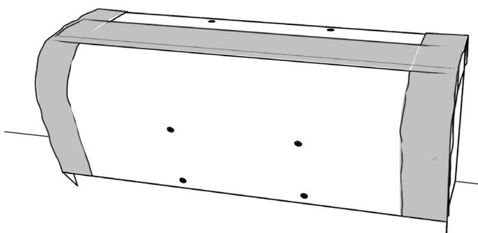
**15)** Le banc est terminé et peut à présent être revêtu. Dans le cas d'un usage en zone de douche un système d'étanchéité liquide doit être appliqué au préalable.
