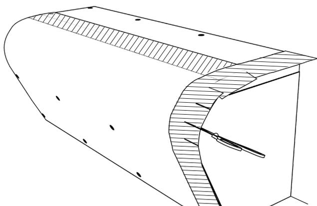
**13)** Tous les raccords perpendiculaires et faces frontales visibles sont dotés de la bande d'armature JACKOBOARD® autocollante. Au niveau des arrondis, la bande d'armature est entaillée au ciseau, puis collée en faisant chevaucher les languettes obtenues.
