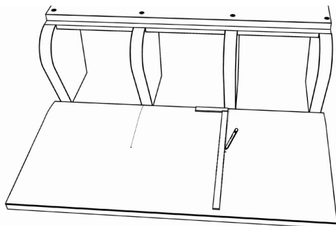
6) Le panneau de recouvrement B2 est positionné afin de tracer les positions des panneaux supports intermédiaires.
