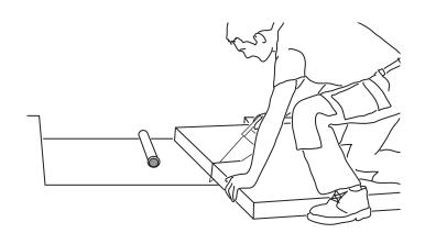
**3)** Sur le dessous d'Aqua Base, déposez uniformément le mortier-colle (colle à carrelage flexible type C2) à l'aide d'une truelle dentée.
