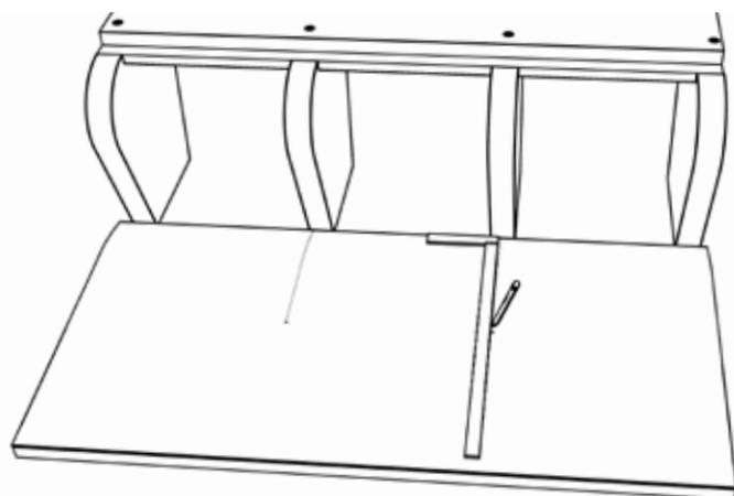
6) Die Abdeckung B2 wird angelegt und die Positionen der mittleren Stützwände angezeichnet.
