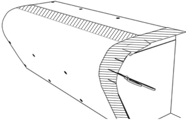
13) Alle Stoßfugen und sichtbaren Stirnkanten werden mit dem selbstklebenden JACKOBOARD® Armierband abgeklebt.
