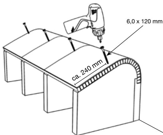
9) Die Sitzbank wird auf den Rücken gelegt. Abdeckung B2 wird fest um die Rundung geführt, angedrückt und angeschraubt.
