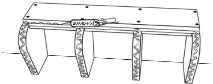
7) Auf den Stützwänden A und an der Längsseite der Abdeckung B1 wird BOARD-FIX® aufgetragen.
