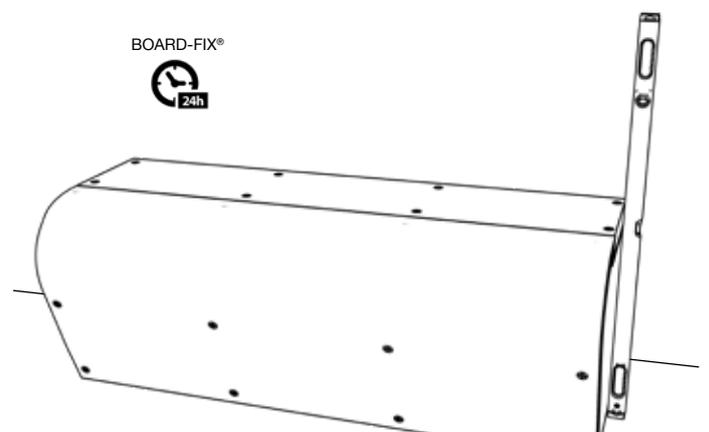
12) Die Sitzbank wird an Wand und Boden angeklebt, so dass sie lotrecht positioniert ist.
