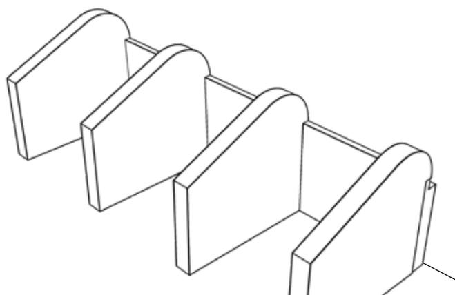
4) Die Abdeckung B1 wird aufrecht gestellt. Die Stützwände A werden angeklebt.
