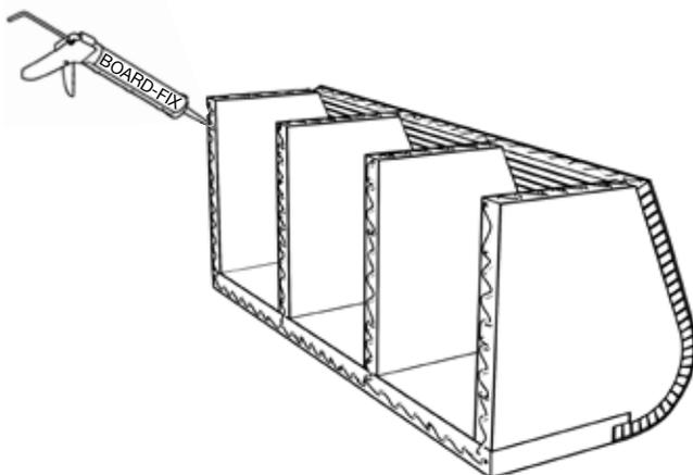
11) Die Sitzbank muss an der Wand und am Boden angeklebt werden. Hierzu wird BOARD-FIX® auf die Stirnflächen der Rückseite und Unterseite aufgetragen.
