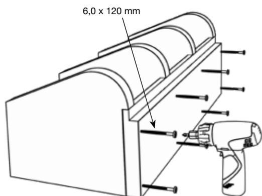
5) Die Stützwände A werden angeschraubt.
