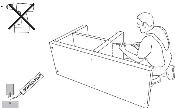
**5)** Nach Auftragen des Klebers an allen Fügeilen wird die Mittelwand mit dem Mittelboden verschraubt.
