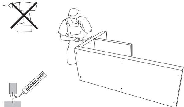
**4)** Kleber an beiden Fügeilen (Seitenwand und Mittelboden) auftragen und Mittelboden anschrauben.
