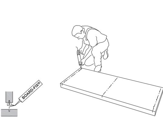
**1)** Kleber wird an beiden Fügeilen (Tischplatte und Seitenwand) aufgetragen.
