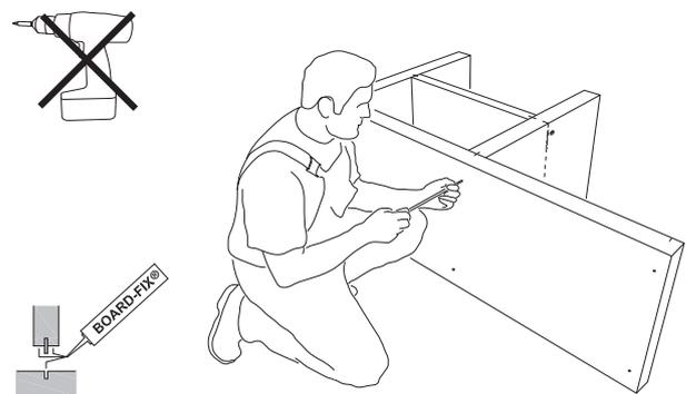
**6)** Anschließend wird die Tischplatte mit der Mittelwand verschraubt.
