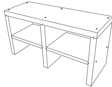
10) Der Waschtisch ist jetzt fertig und kann, nachdem der Kleber ausgehärtet ist (ca. 24 Stunden), direkt verfliesen, verspachtelt oder verputzt werden. Um eine feste Position zu garantieren, muss der Waschtisch an Wand und Boden mit BOARD-FIX® angeklebt werden. Bitte beachten Sie die folgenden Hinweise.
