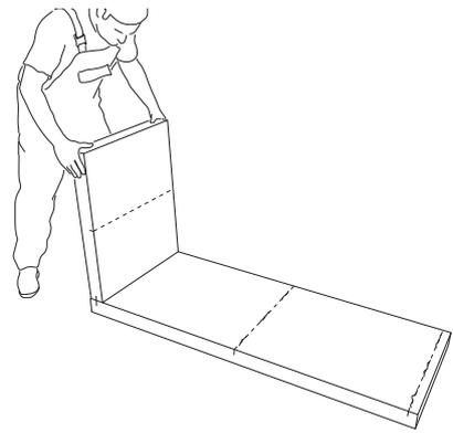
**2)** Seitenwand in die Nut der Tischplatte einschieben.
