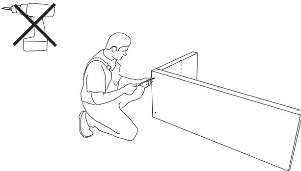
**3)** Die Tischplatte wird mit der Seitenwand verschraubt. Hierfür werden die Schrauben unter Verwendung der Beilagscheiben an den vorgebohrten Löchern angeordnet. Die Schrauben werden mit einem Handschraubendreher soweit angedreht, dass der Schraubenkopf bündig mit der Oberfläche abschließt.
