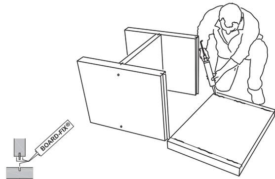
**4)** Kleber wird an beiden Fügeilen (Tischplatte und Seitenwände) aufgetragen.
