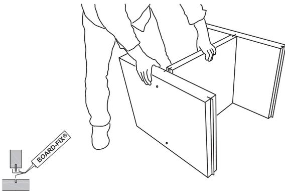
**3)** Konstruktion drehen und Mittelboden in die 2. Seitenwand einstecken.
