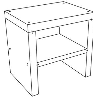
**8)** Der Waschtisch ist jetzt fertig und kann, nachdem der Montagekleber ausgehärtet ist (ca. 24 Stunden), direkt beflies, verspachtelt oder verputzt werden. Um eine feste Position zu garantieren, muss der Waschtisch an Wand und Boden mit BOARD-FIX® angeklebt werden. Bitte beachten Sie die folgenden Hinweise.
