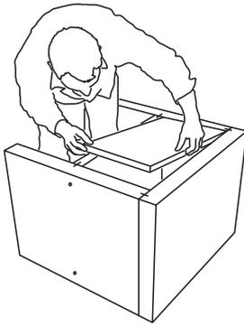
**7)** Montageplatte in das obere Fach des Waschtisches eindrücken. Diese dient der Rechtwinkeligkeit des Waschtisches und wird nach dem Aushärten des Klebers wieder entfernt.
