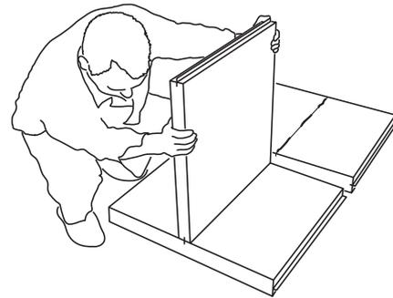
**2)** Mittelboden in die Nut der Seitenwand einstecken. Bündigkeit zwischen Mittelboden und Seitenwand prüfen.
