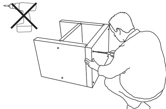
**6)** Der Waschtisch wird zusammengeschraubt. Hierfür werden die Schrauben unter Verwendung der Beilagscheiben an allen vorgebohrten Löchern angeordnet. Die Schrauben werden mit einem Handschraubendreher soweit angedreht, dass der Schraubenkopf bündig mit der Oberfläche abschließt.
