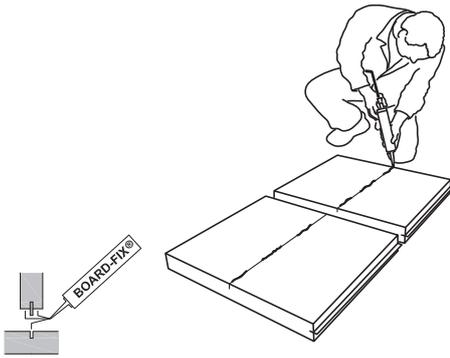
**1)** Kleber wird an beiden Fügeilen (Seitenwände und Mittelboden) aufgetragen.
