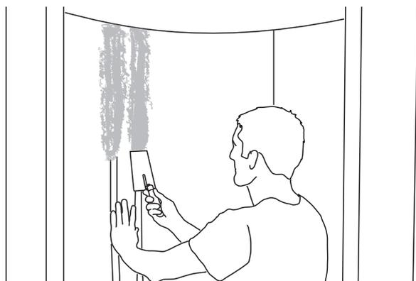
**11)** Alle Längsfugen der Wandelemente werden auf der Innenseite mit dem JACKOBOARD® Armierband unter Verwendung von Fliesenkleber abgespachtelt. Die Stirnkanten im Eingangsbereich sowie die Längsfugen auf der Außenseite werden ebenfalls mit dem JACKOBOARD® Armierband abgespachtelt.
