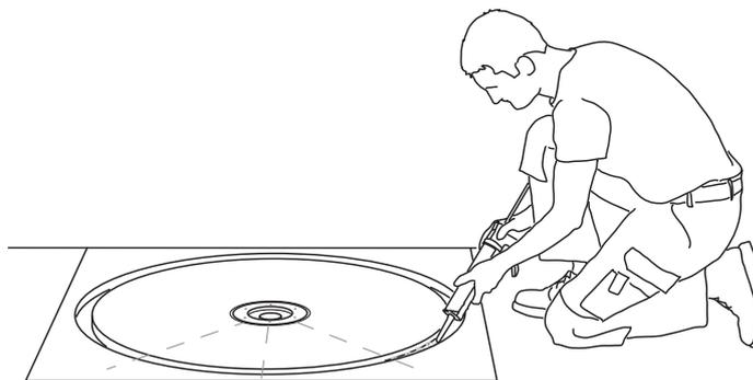
**2)** Zum Befestigen des ersten Wandelementes wird in die eingefräste Nut der Kleb- und Dichtstoff BOARD-FIX® aufgetragen.
