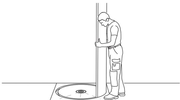
**3)** Das 1. Wandelement wird in die Nut eingesetzt.
