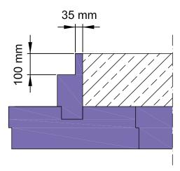
Schalungselement für Abdichtung (mit 35 mm Schaumkante) Nach dem Erstarren des Betons kann die Schaumkante mit dem Cuttermesser getrennt werden.
